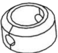
Teil-Nr.: 56 Sicherungsring Menge: 2 Stück
